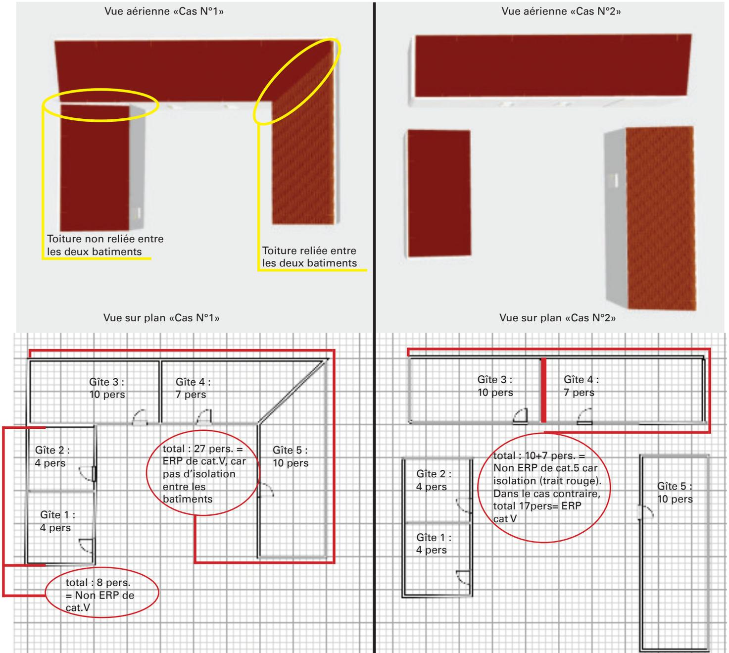
Le Gîte 1 et 2 disposent de la même toiture. Tout comme le Gîte 3 - 4 et 5. Si les gîtes ayant la même toiture ne disposent pas d'une isolation anti-incendie, même s'il y a un mûr de séparation entre chaque gîte de 0,8m, alors l'addition du nombre de personnes susceptible d'être accueillis par gîte sera additionné. Si le nombre dépasse 15 personnes, la structure devra se mettre au norme ERP de catégorie V.
