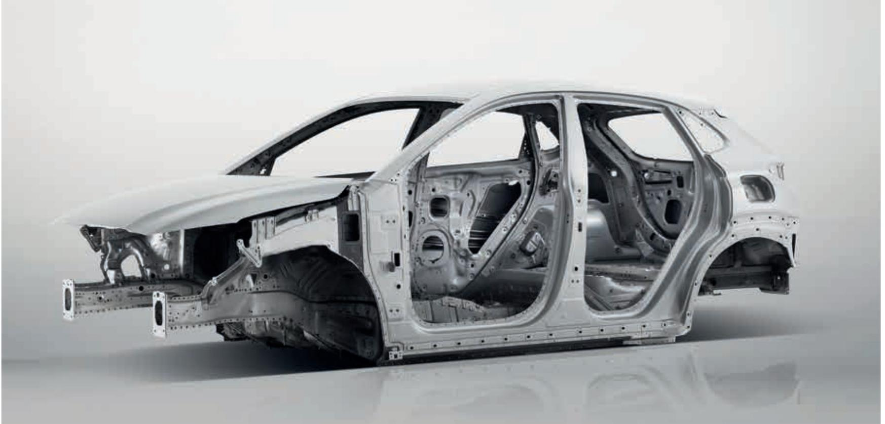
Hyundai a recours à l'acier haute résistance pour améliorer la rigidité et la résistance aux chocs de ses véhicules. De plus, sa structure est prévue pour absorber l'énergie et protéger au mieux les occupants en cas de collision.
