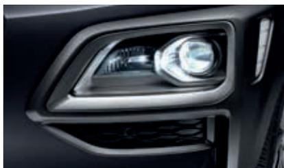
Feux avant bi-LED avec éclairage additionnel en virage
